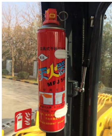
图 1-20 灭火器支架位置
